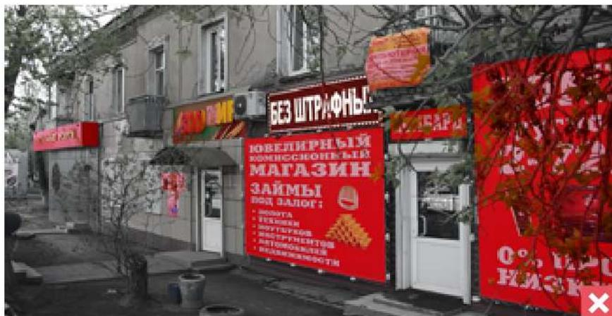
**Почему это плохо?** Использованы недопустимые способы размещения информации: электронное табло («бегущая строка»), оклейка поверхности фасада, использование конструкции, перекрывающей балкон, баннеры на фасаде и на ограждающих конструкциях балкона — и всё это с использованием излишне ярких цветов (красный, желтый, зелёный).
