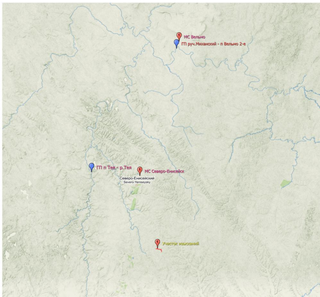
Рисунок 1 - Схема гидрометеорологической изученности территории (гидрологические и метеорологические посты нанесены красными и синими метками)
