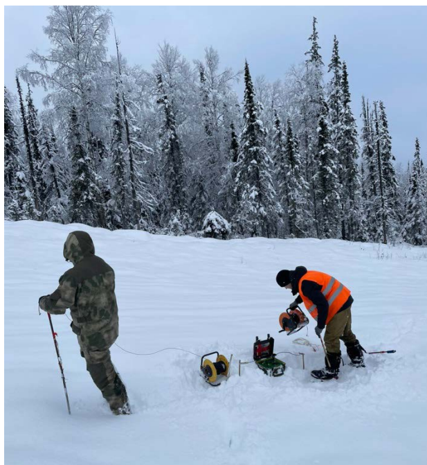
Рис. 11.2 Процесс работ по электроразведке
