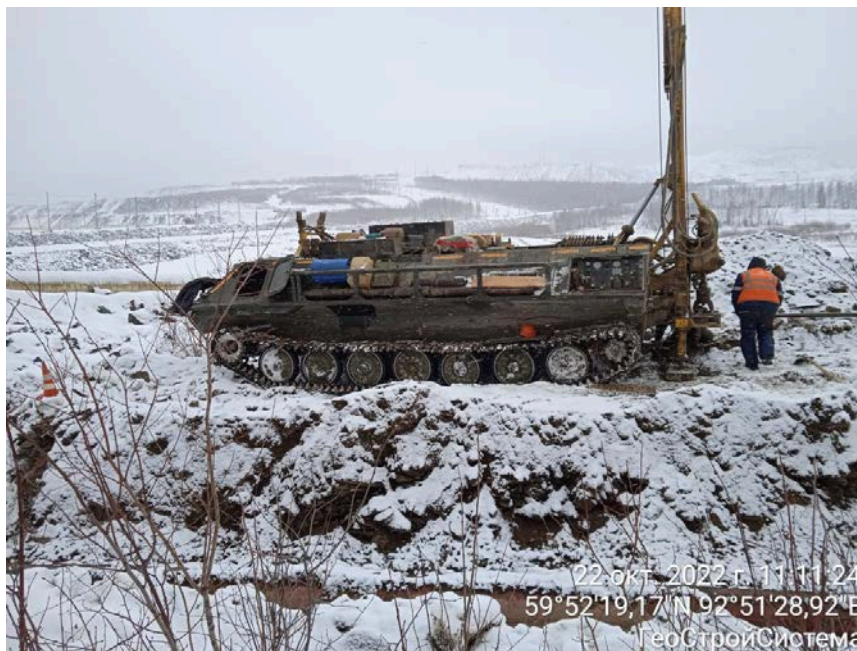
Фото 4.1 Буровая установка УРБ-2А-2 на базе МТЛБу.
