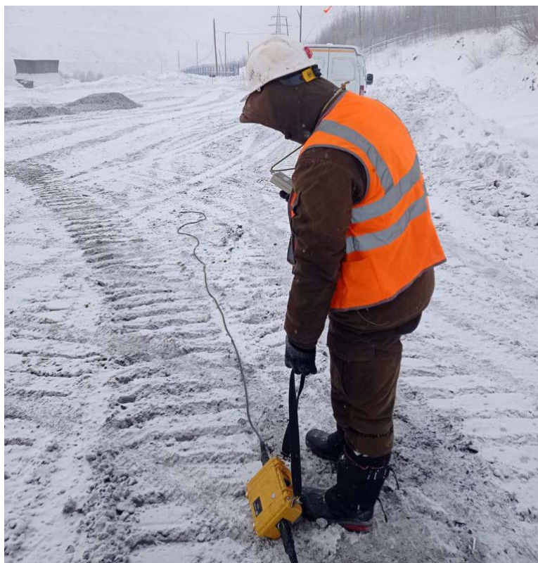
Рис. 11.4 Процесс работ по дипольному электроразведыванию
