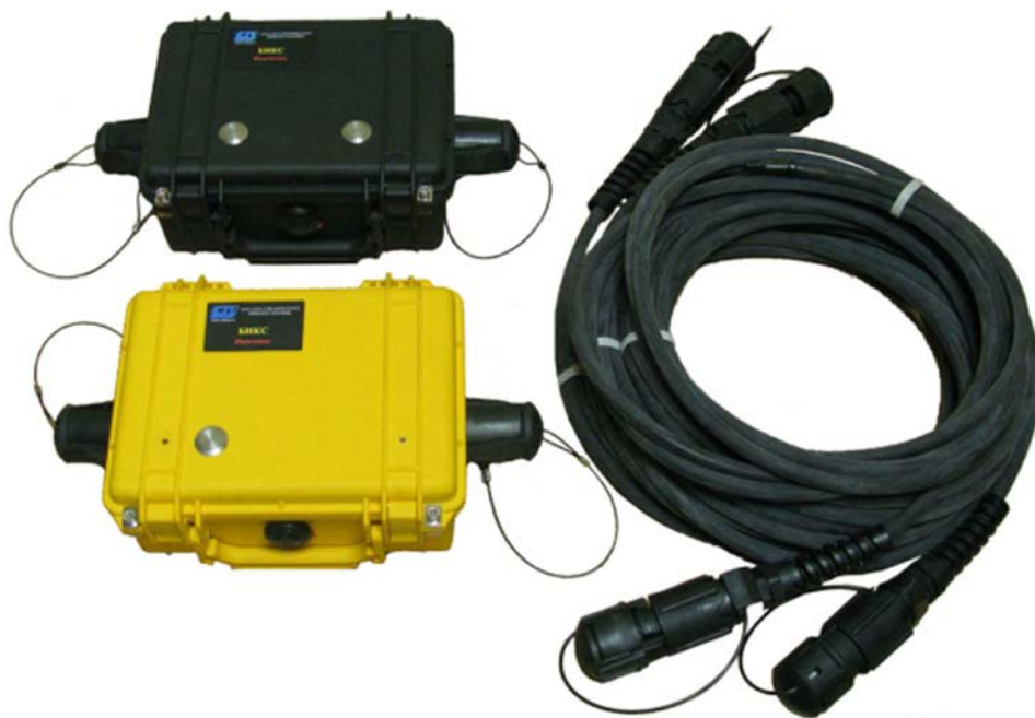
Рис. 11.3. Внешний вид комплекта аппаратуры «БИКС». Генератор, приемник, емкостные шлейфы
