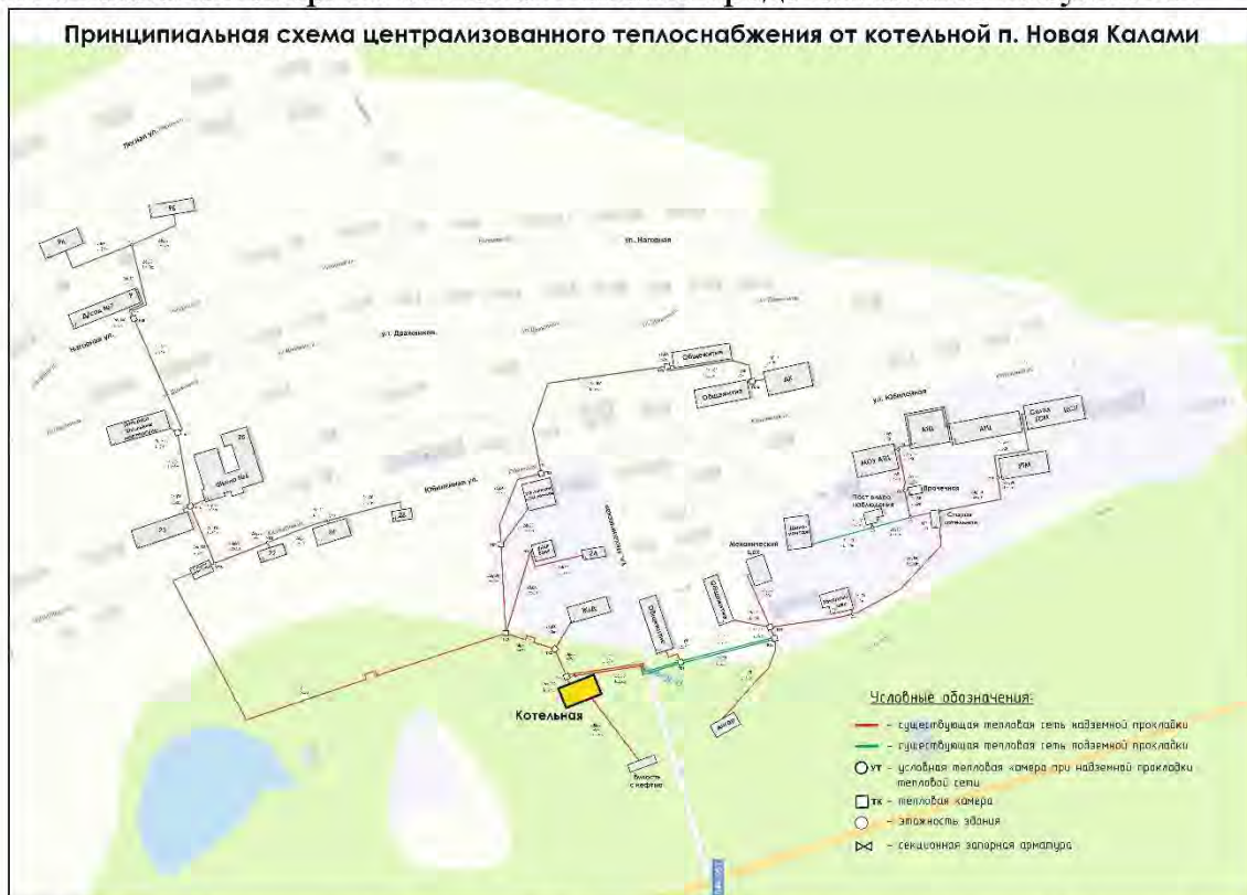
Рисунок 2.1. Существующая зона действия системы теплоснабжения и централизованного источника тепловой энергии п. Новая Калами
