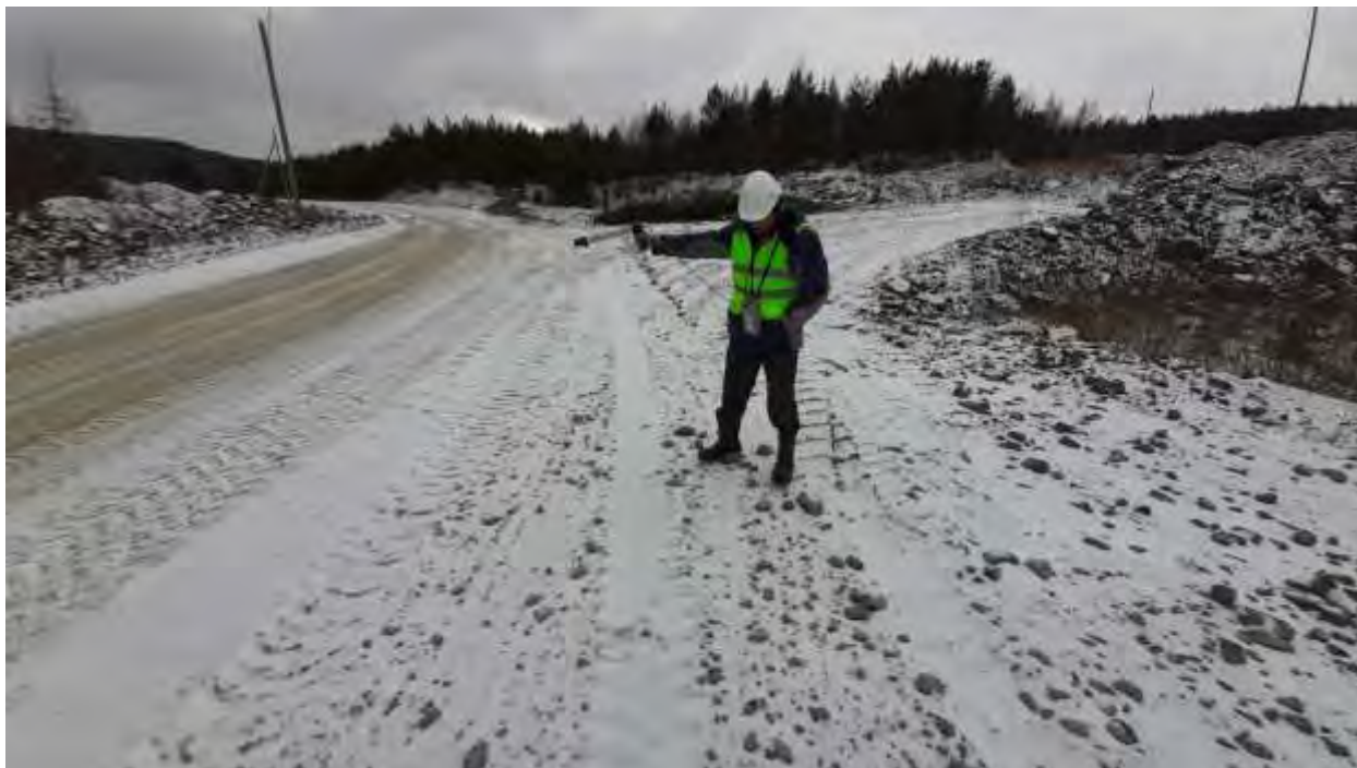
Рисунок 6 – Измерение гамма-фона (МАЭД гамма-излучения на высоте 1 м) с применением дозиметра-радиометра ДКС-96
