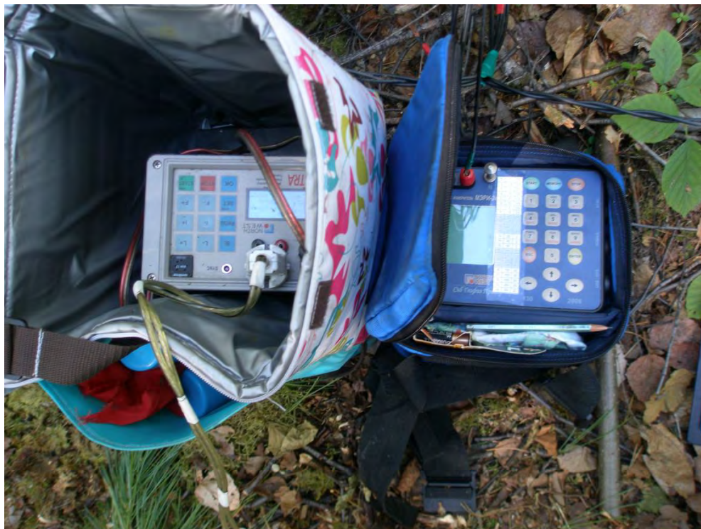
Рисунок 5.1 - Геофизическая аппаратура: Измеритель «МЭРИ-24» в комплекте с генератором «АСТРА-100»
