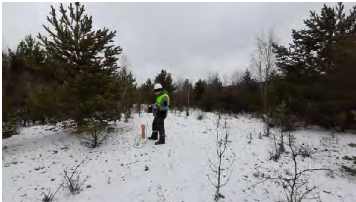
Рисунок 7 – Гамма-спектрометрические измерения (ГСИ) УА ЕРН в условиях естественного залегания почв/грунтов с применением спектрометра МКС-АТ6101Д
