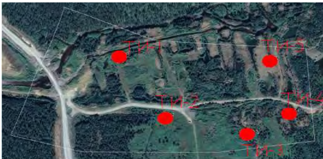
Рисунок 10 – Расположение точек измерения уровней шума и электромагнитных полей промышленной (50 Гц) частоты
